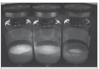
Рис. 2. Высушенные образцы α-амилазы: справа налево без «коллапса», с «микроколлапсом» и с «коллапсом»
