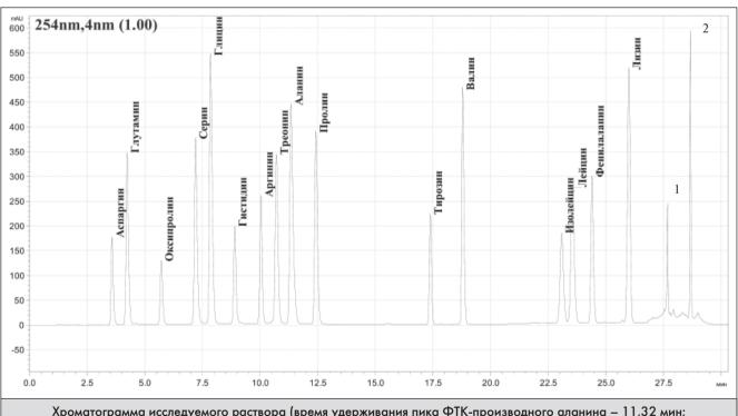
Хроматограмма исследуемого раствора (время удерживания пика ФТК-производного аланина – 11,32 мин; пика ФТК-производного лейцина – 23,41 мин; пика ФТК-производного лизина – 25,90 мин, плацебо (время удерживания пика 1 – 27,59 мин, пика 2 – 28,61 мин)
