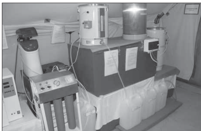
Рис. 6. Получение воды очищенной и воды для инъекций
