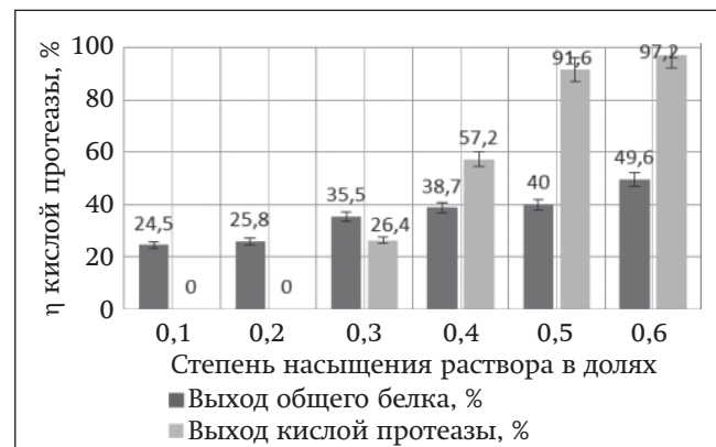
Рис. 5. Осаждение кислой протеазы гриба Aspergillus oryzae шт. 55: 50% кристаллическим сульфатом аммония
