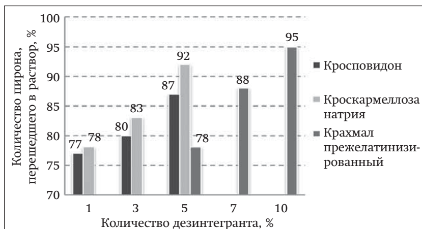
Рис. 2. Зависимость высвобождения пирона от количества дезинтегрантов в составе таблеток-ядер
